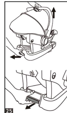
Fig. 25: Coloque la manilla en posición de transporte. Confirme que la manilla está bloqueada en su ubicación. El indicador de la manilla DEBE estar de color verde. Libere la silla de auto de la base y levántela.
