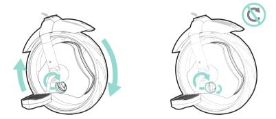
**Atención**: Cuando la barra de empuje no está en uso, por favor gire el mando de la rueda delantera hacia la izquierda en el modo de triciclo, para evitar el riesgo de vuelco o colisión causada por un ajuste incorrecto de la estructura.
